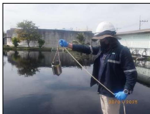
น้ำทิ้งในบ่อ Holding Pond 2 ก่อนสูบออกทะเลของระบบ Aerated Lagoon & Activated Sludge ของเขตอุตสาหกรรมทั่วไป (พื้นที่โครงการระยะที่ 1)
