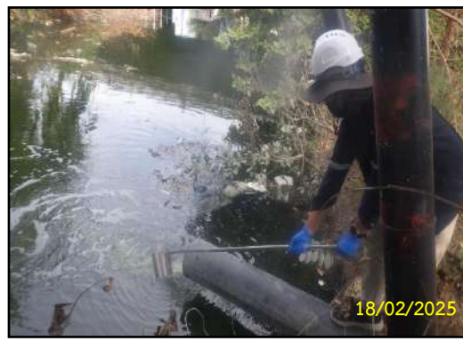
น้ำทิ้งที่ออกจากระบบฆ่าเชื้อโรค (ก่อนระบายผ่านระบบเส้นท่อลงทะเล) Automatic Screening ของระบบ Extended Activated Sludge ของพื้นที่โครงการระยะที่ 2
