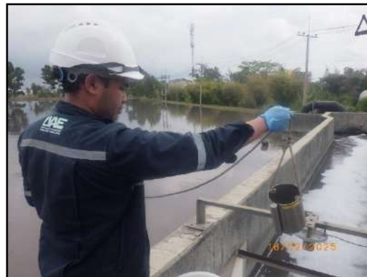
น้ำเสียก่อนเข้าบ่อที่ 1 (บ่อ Aerate Lagoon) ของระบบ Activated Sludge ของเขตอุตสาหกรรมทั่วไป (พื้นที่นิคมฯ ระยะที่ 1)
