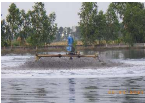
รูปที่ 2-5 เครื่องเติมอากาศ
